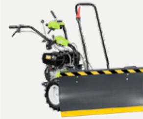
Version avec lame orientable de 100 cm GH 8 - GH 9
