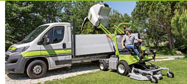
Les commandes des services hydrauliques (bac et coupe) s'effectuent par des leviers spéciaux et ergonomiques à coté du poste de conduite: un système de sécurité empêche le mouvement des leviers en cas des touches accidentelles. Grâce aux vérins hydrauliques la vidange du bac et le soulèvement de la coupe pour passer les bordures sont très faciles et rapides.
