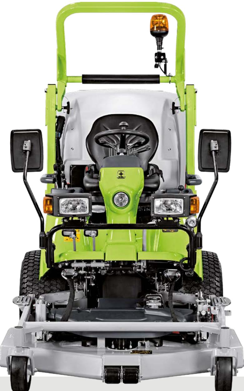
FD 900 est équipée d'un moteur diesel Yanmar 3TNV80F à 3 cylindres de 25HP répondant déjà aux normes EC (NRMM) Stage V et EPA Final Tier 4 (USA).
