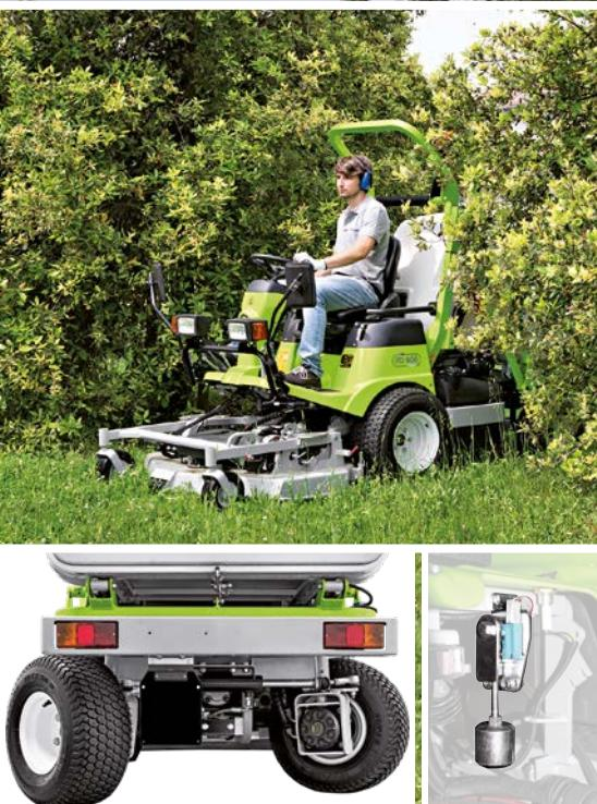
Système de stabilité avec blocage automatique du différentiel.
