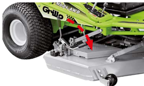
Corte con descarga trasera: cámara de corte abierta
