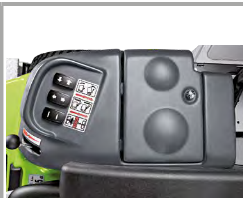
Comandos con interruptores eléctricos
