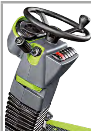
Columna de dirección con pantalla LCD
