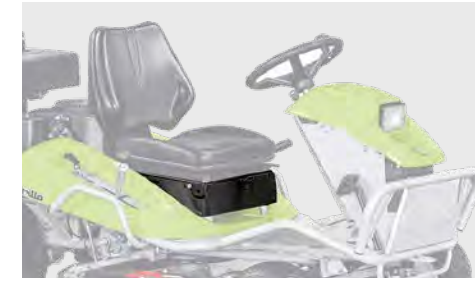
Federung für Sitz für MD 15 und MD 28, (Standard bei anderen Modellen).
